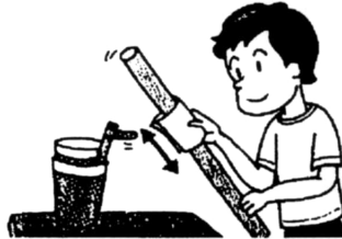
図2.アクリル棒と塩化ビニール棒を使った静電気の起こし方
